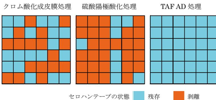
図 3. クロスカット剥離試験の結果
