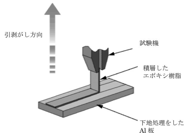
図 1. 90° 引剥がし密着強さ試験の方法
